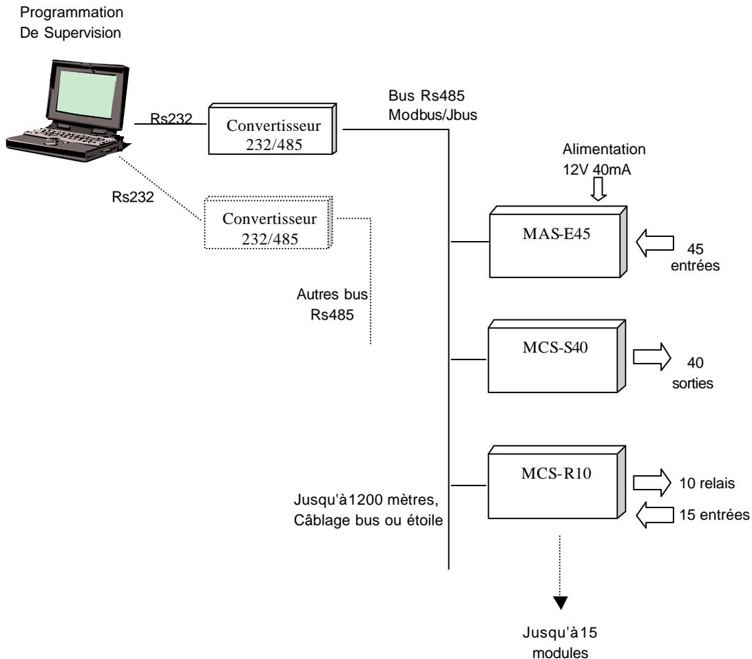
Câble Bus: 1 paire torsadée blindée. Le blindage et la continuité assure l'équipotentialité de l'ensemble des modules et du convertisseur. Il est conseillé d'utiliser un convertisseur isolé.
