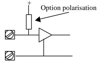
*Contact , transistor ou opto, avec surveillance de ligne:*
